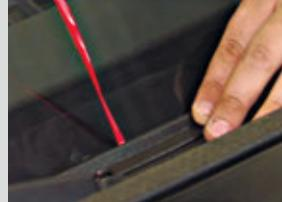
Удалите полностью защитную пленку и зафиксируйте деталь на автомобиле.
