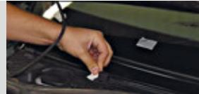
Нанесите активатор адгезии согласно разметке и в места прилегания.
