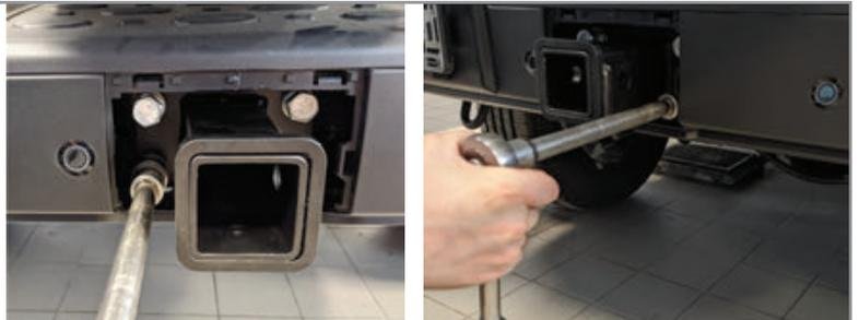
**ШАГ 4.** Установите фиксирующий болт М10х20 снизу, он используется для исключения технологических люфтов съёмного шара и только в ненагруженном состоянии! Перед сцепкой болт демонтировать! Установка завершена.
